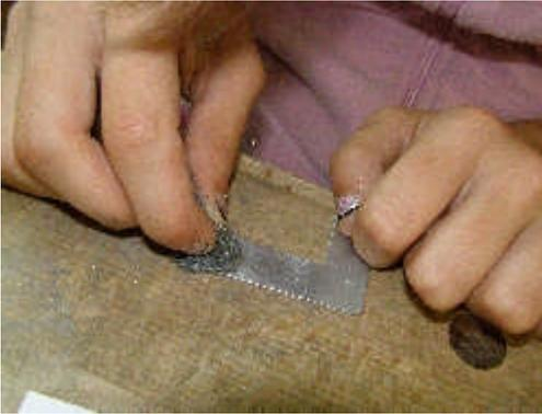
Die Oberflächen können mit Stahlwolle poliert werden. Allerdings muss diese Arbeit zum Ende nochmals wiederholt werden, da beim Biegen natürlich Abdrücke auf dem Material entstehen.
