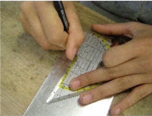
Zuerst werden die Maße des Werkstücks auf die Aluminiumplatte gezeichnet.
