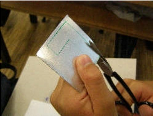
Anschließend wird das benötigte Blechstück mit der Feinblechschere ausgeschnitten.
