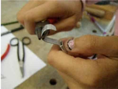
Anschließend wird der restliche Streifen vom Mundstück nach unten gebogen und vorne zu einer Rundung gebogen, um eine Pfeifenform zu erhalten.
